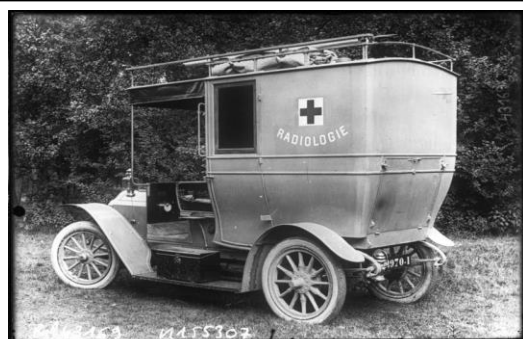
Figura 1: Vehículo de rayos X inventado por Marie Curie. Foto tomada de: www.theconversation.com
